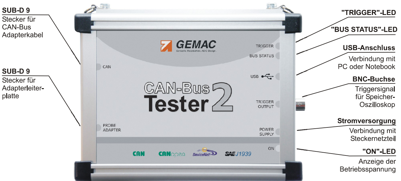
Abbildung 1: Anschlüsse des CBT2
