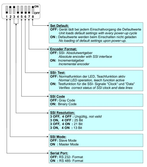
Die oben gezeichnete Schalterstellung entspricht dem Master- Betrieb eines 25-Bit SSI- Gebers mit Gray- Code- Ausgang. Die serielle Schnittstelle ist auf RS232-Kommunikation eingestellt.
