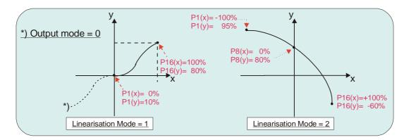
Sie können die programmierte Kurve auf einem externen Oszilloskop oder auf dem PC sichtbar machen. Wählen Sie hierzu bei TOOLS das Testmenü und dort die Funktion "Analogue Voltage Function". Das Gerät simuliert dann repetierend eine Geberbewegung über den ganzen Bereich und steuert den Analogausgang entsprechend aus. Für die Oszilloskop- Funktion der Bedienersoftware gilt hierfür der serielle Code ":1 ".
