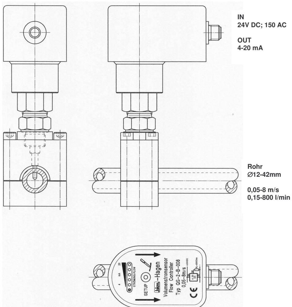
Der Volumenstromsensor QS-2-B eröffnet neue Möglichkeiten für den Betrieb und Überwachung von hydraulischen Anlagen.
