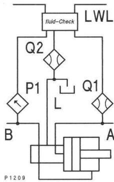
Differential-Zylinder mit rotierender Ölzuführung
