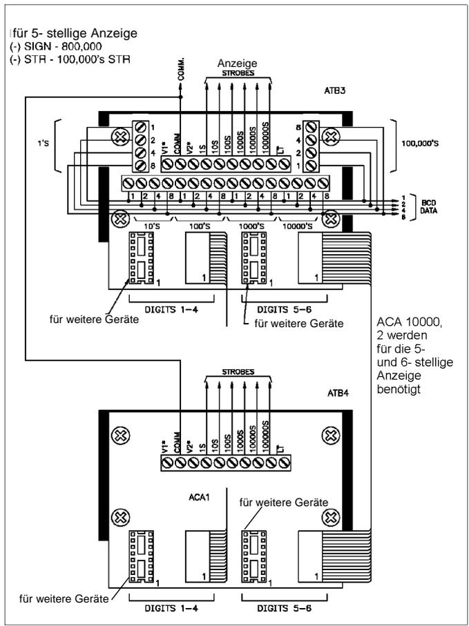
Anschlußbild mit Klemmleistenplatte
